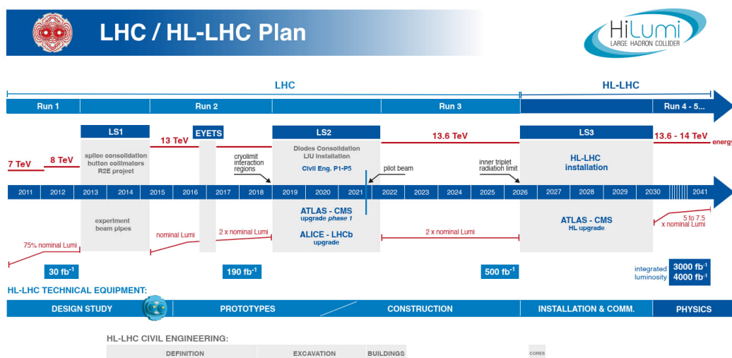
図 1.8: LHC アップグレード計画 [13]。2022 年から 2026 年まで Run 3 としてデータ取得が行われ、その後 2030 年までのアップグレード期間 (LS3) を経て、高輝度 LHC (HL-LHC) の運転が開始される予定である。
