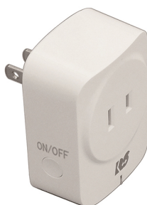
図 4.17: 使用したワットチェッカー RS-BTWATTCH2 [56]。
