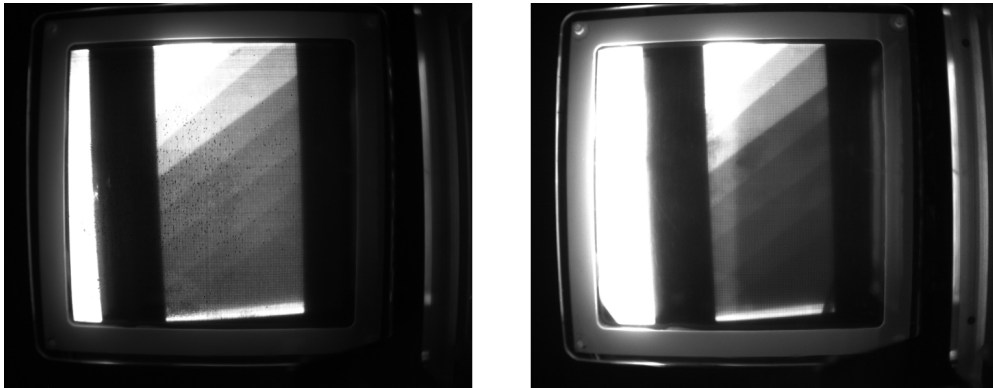
図 5.30 アルミニウム箔 X 線イメージ、左：陽極高さ 125 \mu\text{m} 、右：陽極高さ 75 \mu\text{m}
