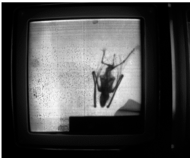
図 5.21 コウモリのイメージ (陽極高さ 125 \mu\text{m} )
