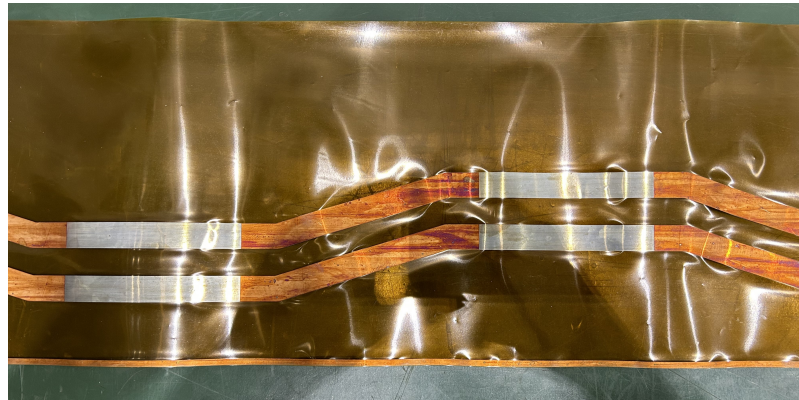
図 2.4: クエンチ保護ヒーターのヒーターストリップ
