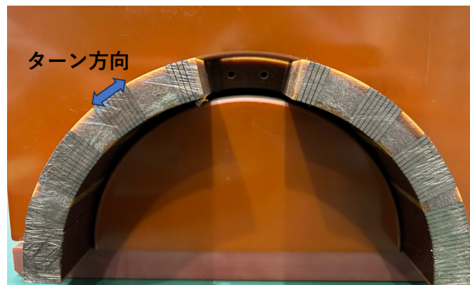
図 3.11: コイル模型：ターン方向を図に示す。
