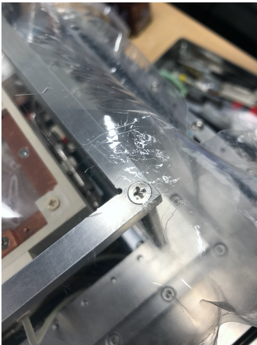
図 3.23: TPC 内部構造との接触による EVOH の損傷。
